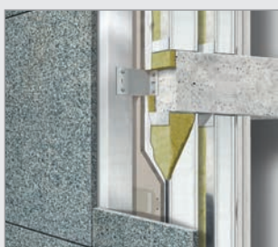
جزئیات اجرای دیوار پوششی با سنگ خشک
