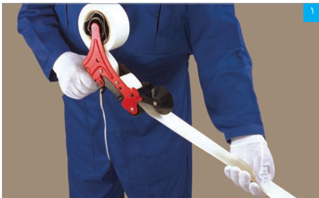
خم کردن نوار درزگیر با دستگاه تازن
